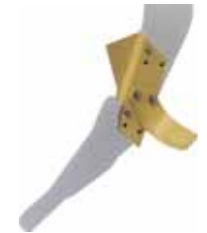
Esplosori ad alette , le alette laterali regolabili permettono una maggiore esplosione e ribaltamento del terreno in superficie.
