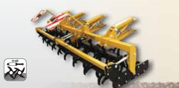
Franter H-40 pieghevole con regolazione di profondità IDRAULICA , per modelli KX (Ø 195mm)
