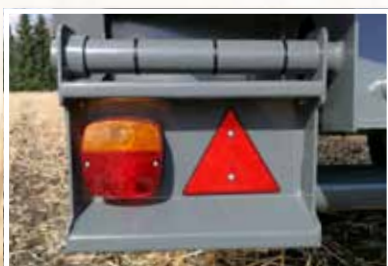
Маятниковое крепление задних фонарей (защитная решетка в качестве опции).
