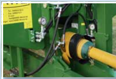
Тяговое дышло с гидравлической амортизацией (нижняя сцепка).
