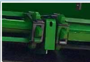
Привод плоскозвеньевых цепей с помощью высокопрочных звездочек.
