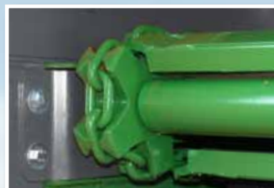
Вал донного транспортера оснащен тремя подшипниками. Высокая степень очистки благодаря скребкам на каждой цепной шестерне.
