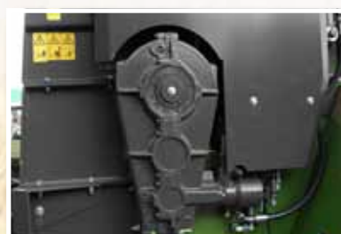
Донный транспортер приводится в действие с помощью цилиндрической зубчатой передачи, предусмотрена центральная смазочная подшипников измельчающих валов.
