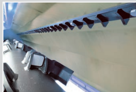
Lamiera di consumo e doppio controcoltello Wear and tear metal plate and double counter-knife Chapa de blindaje y contra-cuchillas
