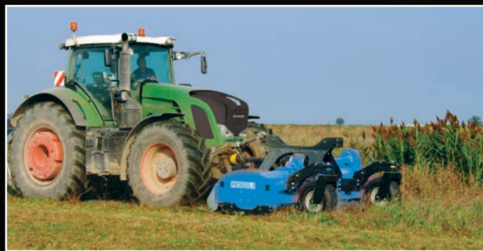
BCR – Trinciatura più omogenea in posizione frontale poiché il trattore non calpesta la vegetazione BCR – A more homogeneous shredding in front position, as the vegetation is not pressed by the tractor wheels BCR – Trituración más homogénea en posición frontal porque el tractor no rueda encima de los vegetales
