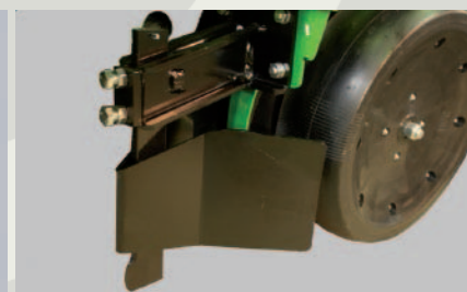
8 Лемех, регулируемый по высоте, с независимым сошником, также регулируемым.
