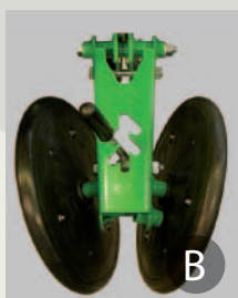
9 Возможность выбора между типами колёс: окучниками в форме "V", самоочищающимися, широким 2" (A) или узкими, самоочищающимися, шириной 1" (B); железными (C) и резиновыми farmflex (D).
