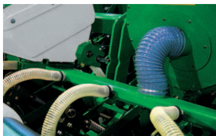
Работа бесшумной турбины высокой мощности и производительности может обеспечивать питанием до 18 элементов с ВОМ 540 об/мин (возможен заказ на 750 об/мин или на 1000 об/мин). В моделях с жёсткой рамой (начиная с 12 рядов кукурузы и 18 рядов свеклы и для всех моделей со складной телескопической рамой) применяется металлический коллектор.
