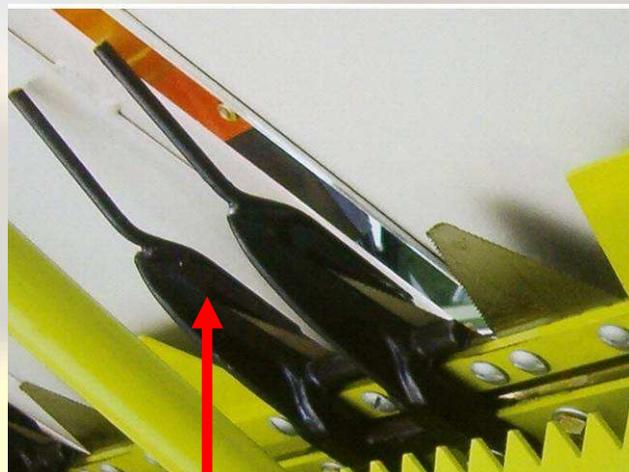
Направляющие зубцы ножа компании Claas с ограниченной из-за конструкции зубца зоной резки, создаёт заторы на ноже и ограничивает зону резки.
